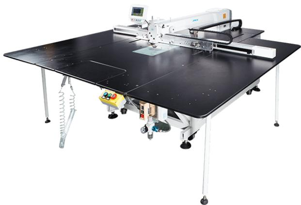
1400\*950 ПОЛЕ ШИТЬЯ. ВИНТОВАЯ ПЕРЕДАЧА. ОДИН ШТЫРЬ ПРОДВИЖЕНИЯ, ЛАЗЕРНАЯ РЕЗКА, ДАТЧИК НИЖНЕЙ НИТИ.
