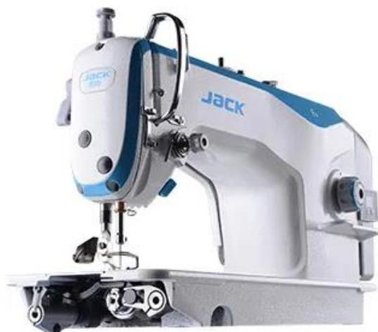
Одноигольная машина челночного стежка с плоской платформой, нижним транспортером и встроенным серводвигателем. Преимущества: Автоматическая система смазки Подсветка рабочей зоны Встроенный в голову серводвигатель с блоком управления Применение: Для стачивания средних и тяжёлых материалов.
