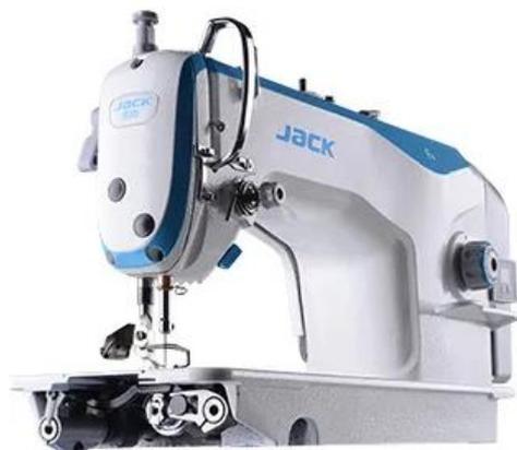
Одноигольная машина челночного стежка с плоской платформой, нижним транспортером, встроенным серводвигателем и увеличенным челноком
