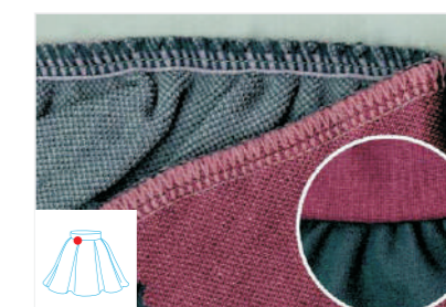
Четырехниточный шов со сборкой ткани P18
