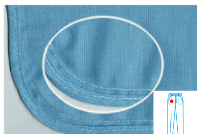
Двухгольный стачивающий шов с окантовыванием P15
