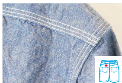
Трехгольный цепной шов P10
