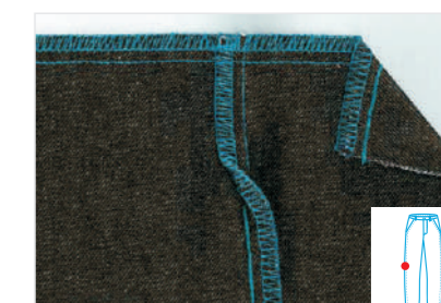
Пятиниточный шов для тяжелых материалов P15
