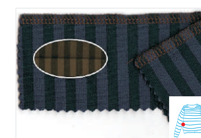
Четырехниточный дифференциальный шов с верхним продвижением P18
